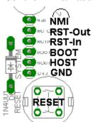
Hier stehen zusätzliche Pins der C-Control II als Lötpads zur Verfügung: Non-Maskible-Interrupt, Reset-Out, Reset-In, Boot, Host, GND
