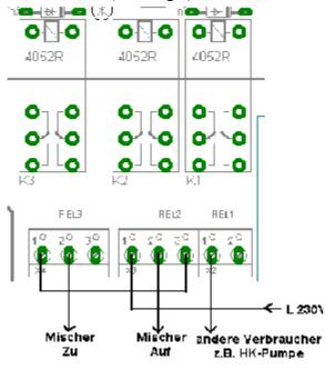
Heizungsmischer-Motoren sollten wie links abgebildet angeschlossen werden, um mögliche Kurzschlüsse und somit die Zerstörung von Mischermotoren z.B. durch Programmfehler verursachtes versehentliches gleichzeitige Schalten von "Mischer-Auf" und "Mischer-Zu" zu vermeiden. Wird ein Mischer, wie links abgebildet, angeschlossen, fährt dieser dann zu, wenn beide Relais einschalten. (Diese Verschaltung gilt für Antriebe aller Art, welche zwei getrennte Leitungen für AUF/ZU besitzen)
