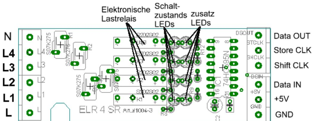
Steuerspannung: 5V DC
